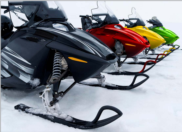
Anwendungen im Außenbereich weisen eine Kratzbeständigkeit auf und behalten ihren gewünschten Glanz mit schlagzähmodifizierten Hochglanz-Polyamid-Copolymeren.
